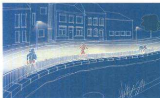
- Optique Lensoflex®2 "Rue étroite" 5098 - Pour une classification 5 selon CIE 115
